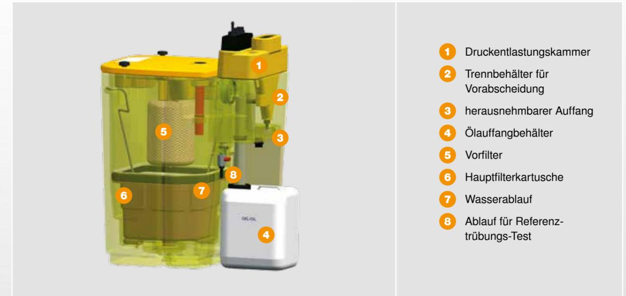
Das ölhaltige Kondensat gelangt unter Druck in die **Druckentlastungskammer (1)**. Dort wird der Überdruck abgebaut, ohne dass es zu Verwirbelungen im nachfolgenden **Trennbehälter (2)** kommt. Mitgeführte grobe Schmutzpartikel werden in einem **herausnehmbaren Auffang (3)** zurückgehalten. Im Trennbehälter setzt sich durch die Schwerkrafttrennung das Öl an der Oberfläche ab. Es wird in den überlaufsicheren **Ölauffang-Behälter (4)** geleitet. Das so vorgereinigte
