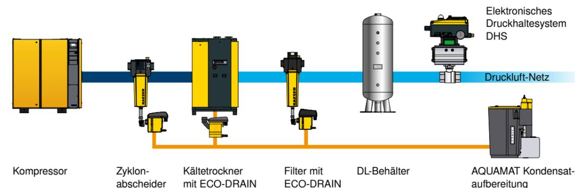
An allen Kondensat-Sammelstellen des Druckluftsystems muss eine zuverlässige Ableitung vorhanden sein. Dies geschieht am besten durch elektronisch geregelte Kondensatableiter.
